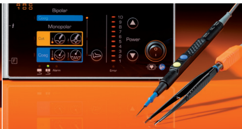
Переключение не требуется: рукоятка-держатель электродов и пинцет могут активироваться от ножного переключателя. Кнопки также позволяют активировать электроды непосредственно на рукоятке
